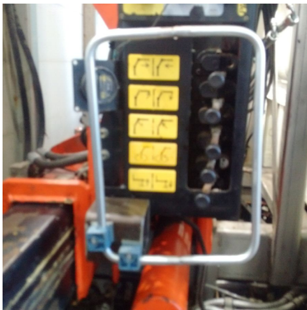
Kuva 3.2: Putkesta tehty vipusuoja ennen maalausta ja oikaisua.
